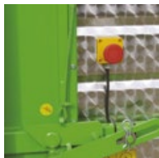
Desconexión automática del botón de emergencia en ambos lados
