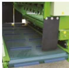
Lona L: Cinta de descarga lateral de 750 mm
