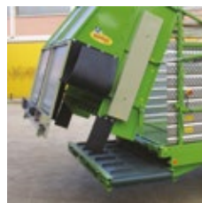
Abertura de la compuerta para descarga trasera y lona de descarga retráctil
