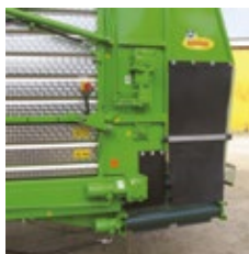
Cajas de engranajes y motores hidráulicos
