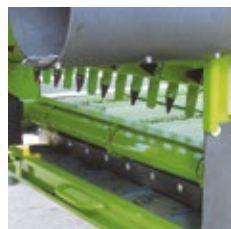
Lona de descarga lateral retráctil
