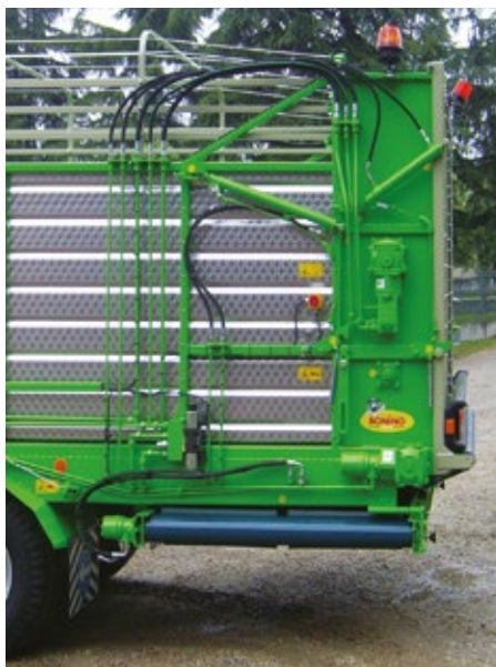
DESCARGA LATERAL CON RODILLOS DOIFICADORES Y ALFOMBRA L=1400 mm RETRACTIL HIDARULICAMENTE
