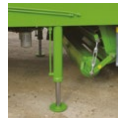
Pies hidráulicos de apoyo y rodillo de apoyo de la cinta transportadora autocargadora
