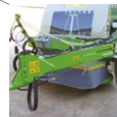
Barra de tracción doble con bastidor reforzado
