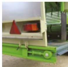
Lona con tensores de tensión controlada
