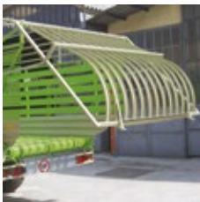
APERTURA DE COMPUERTA HIDRÁULICA
