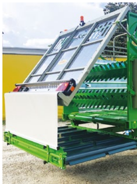
DESCARGA LATERAL CON RODILLOS DOIFICADORES Y ALFOMBRA L=1400 mm RETRACTIL HIDARULICAMENTE
