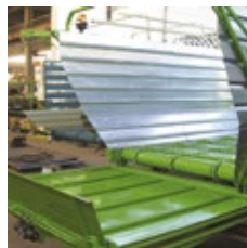
DESCARGA LATERAL MEDIANTE LONA Compuerta abierta
