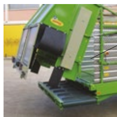
Apertura de compuerta para descarga trasera
