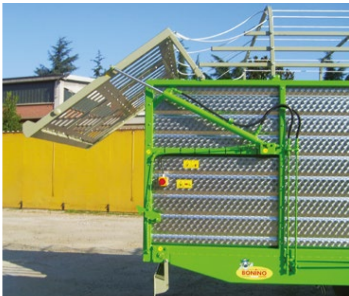
ABERTURA DE COMPUERTA HIDRÁULICA
