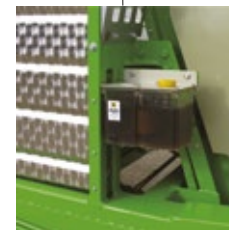
Lubricación automática de la cinta transportadora autocargadora
