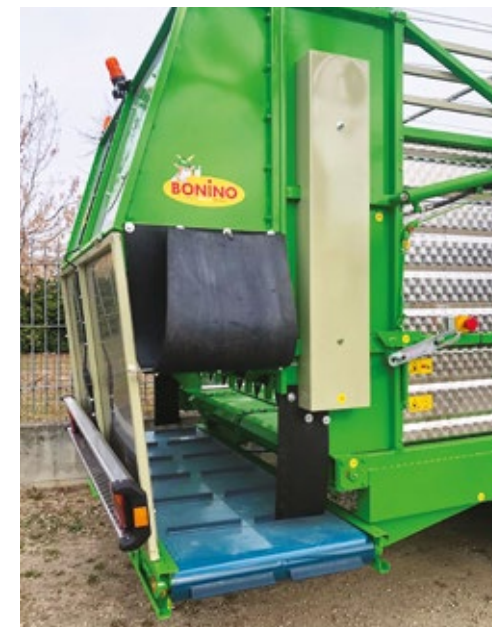
DESCARGA LATERAL CON RODILLOS DOSIFICADORES Y ALFOMBRA L=750 mm RETRACTIL MANUALMENTE
