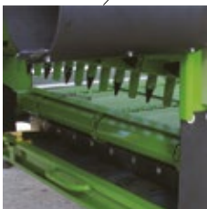
Lona de descarga lateral ajustable manualmente
