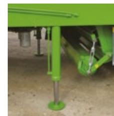
Piedini idraulici di appoggio e rullo di appoggio scala autocaricante
