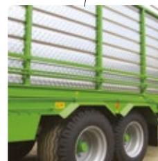
Sponde laterali in acciaio inox fioretato, coperchio, serbatoio olio, lamiera fondo scala e carter su punta rotativa in acciaio inox
