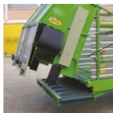
Back hydraulic unloading door
