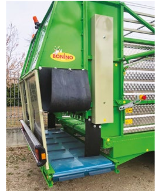
SEITLICHE ENTLADUNG MIT KRATZBODEN ZU L=750 mm UND DOSIERWALZEN, MANUELL ARRETIERTER
