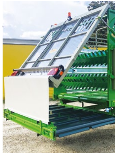
SEITLICHE ENTLADUNG MIT KRATZBODEN ZU L=1400 mm UND DOSIERWALZEN, HYDRAULISCH ARRETIERTER
