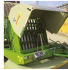
Kasten aus glasfaserverstärktem Kunststoff mit Öffnungssystem für den Zugang zur Selbstladevor- richtung
