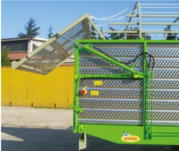
HYDRAULISCHE ÖFFNUNG HECKBORDWAND
