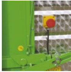
Automatisches Abkuppeln Not-Halt-Taster auf beiden Seiten
