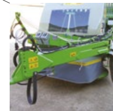
Deichsel mit verstärktem Doppelrahmen
