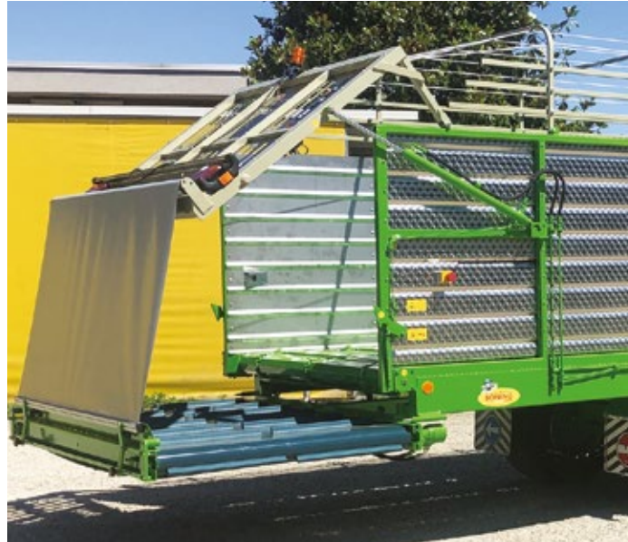
SEITLICHE ENTLADUNG MIT KRATZBODEN L=1400 mm HYDRAULISCH ARRETIERBAR
