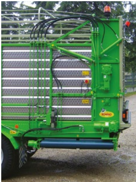
SEITLICHE ENTLADUNG MIT KRATZBODEN ZU L=1400 mm UND DOSIERWALZEN, HYDRAULISCH ARRETIERTER
