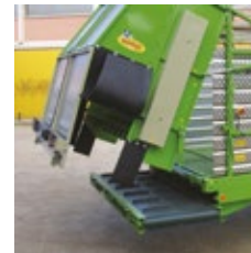
Ouverture de la porte pour déchargement arrière et tapis de déchargement rétractable
