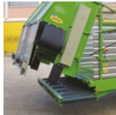
Ouverture de la porte pour déchargement arrière
