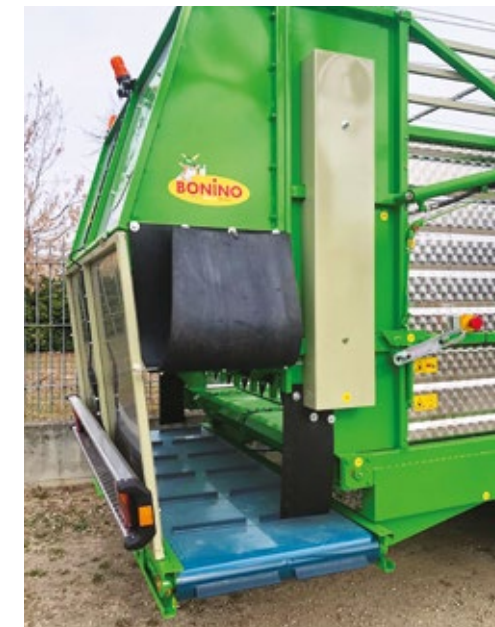
DÉCHARGEMENT LATÉRAL À ROULEAUX DE DOSAGE AVEC TAPIS DE DÉCHARGEMENT LATÉRALE L=750 mm RÉTRACTABLE MANUELLEMENT
