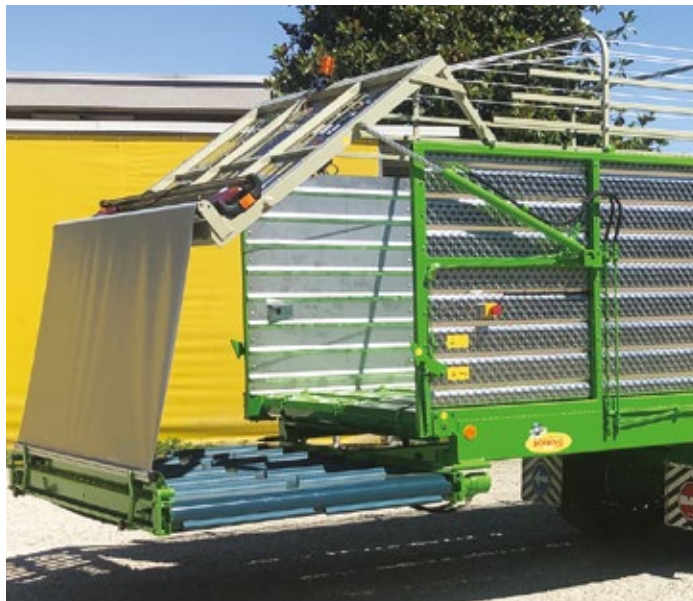
DÉCHARGEMENT LATÉRAL À TAPIS L=1400 mm RÉTRACTABLE HYDRAULIQUEMENT
