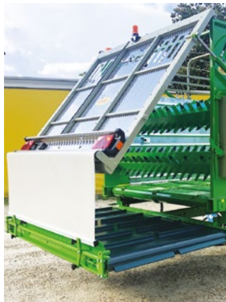
DÉCHARGEMENT LATÉRAL À ROULEAUX DE DOSAGE AVEC TAPIS DE DÉCHARGEMENT LATÉRALE L=1400 mm RÉTRACTABLE HYDRAULIQUEMENT
