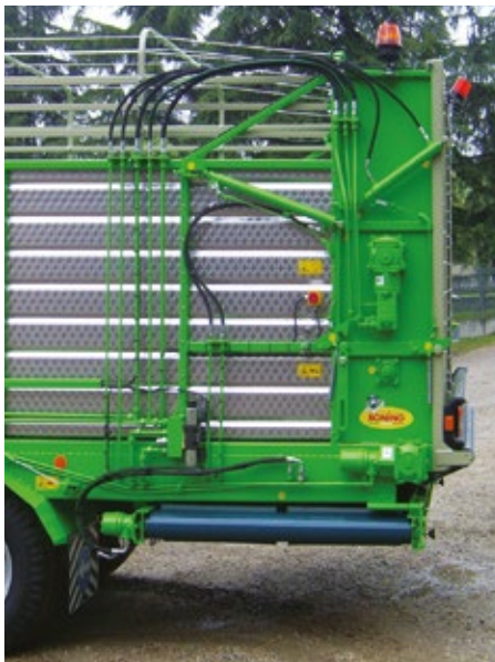
DÉCHARGEMENT LATÉRAL À ROULEAUX DE DOSAGE AVEC TAPIS DE DÉCHARGEMENT LATÉRALE L=1400 mm RÉTRACTABLE HYDRAULIQUEMENT
