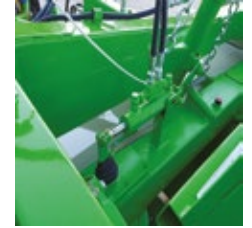
Débrayage avec vérin hydraulique
