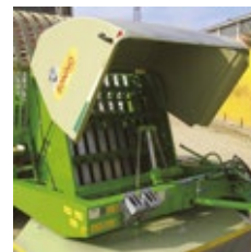
Capot en fibre de verre avec système d'ouverture pour accéder au compartiment de l'échelle autochargeuse
