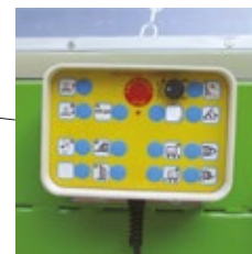
Boîtier de commande électrique avec système de réglage de la vitesse du tapis de déchargement et bouton d'arrêt d'urgence de la machine
